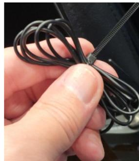
Überschüssige Länge des Kabels zusammenbinden.
